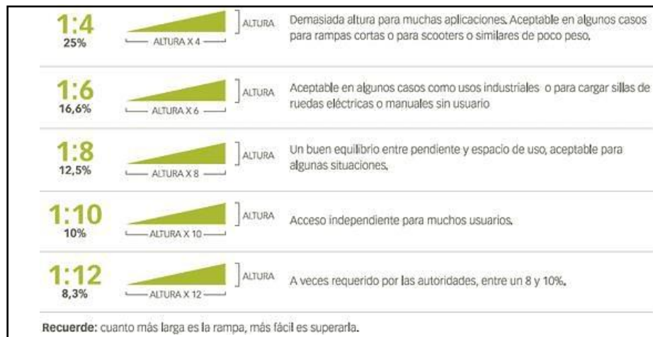
Ilustración 28. Condición de porcentaje en rampas, según funciones
