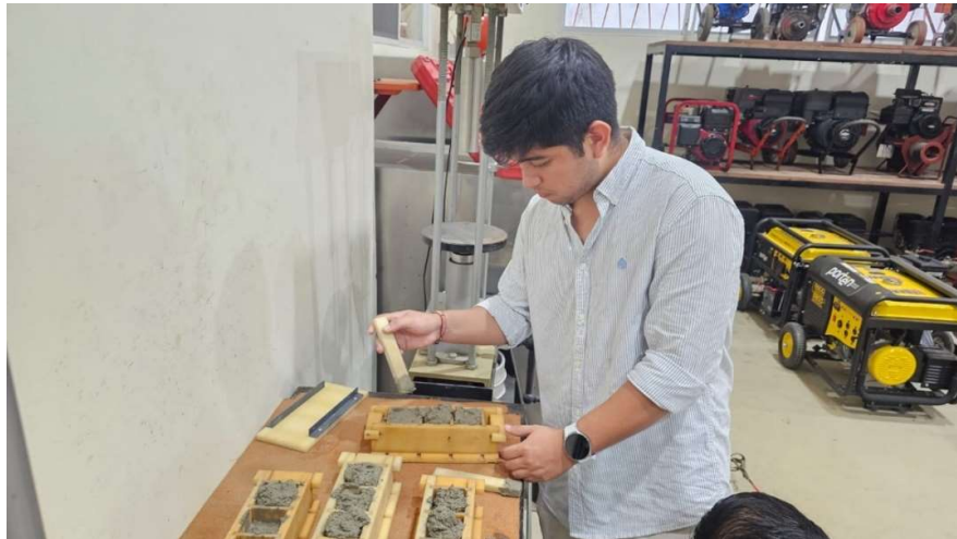
Imagen 36: Realizado de varillado en dos direcciones
