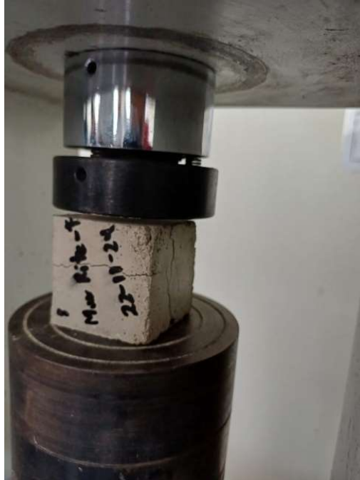
Imagen 54: Calibración de la máquina de ensayos de compresión de cubos
