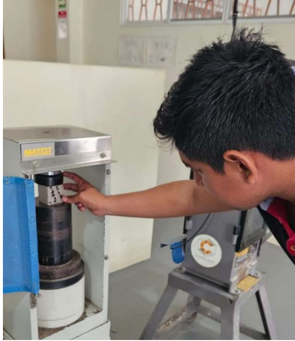
Imagen 52: Rotura de cubos a los 7 días.
