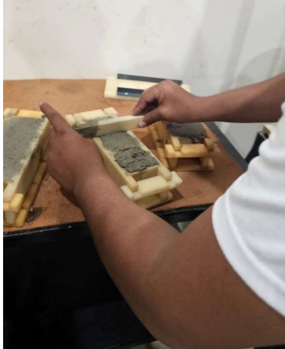
Imagen 38: Paleteado y acabado de los moldes
