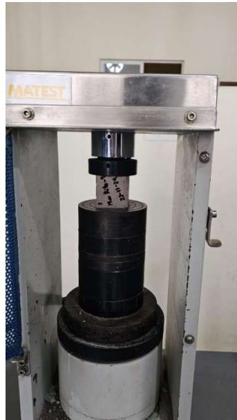
Imagen 56: Rotura de cubo de mortero MAXRITE – F a los 21 días
