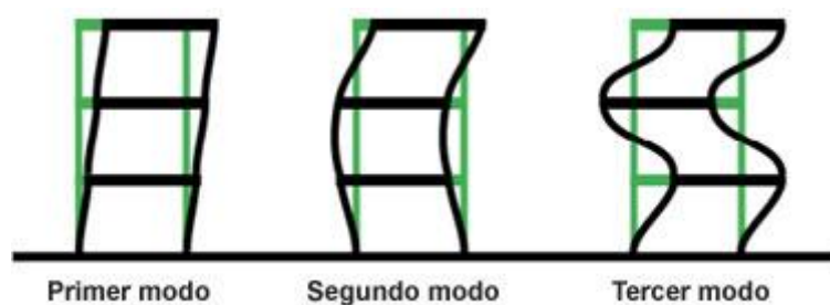
Ilustración 7. Modos de vibración de un edificio
