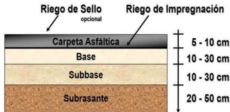
**Nota:** El pavimento flexible se compone de la capa de rodadura, base, subbase y subrasante, que distribuyen cargas y aseguran su durabilidad (Giordani & Leone, s.f.).
