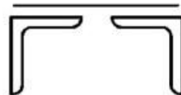
b) Dos ángulos separados unidos con placa
