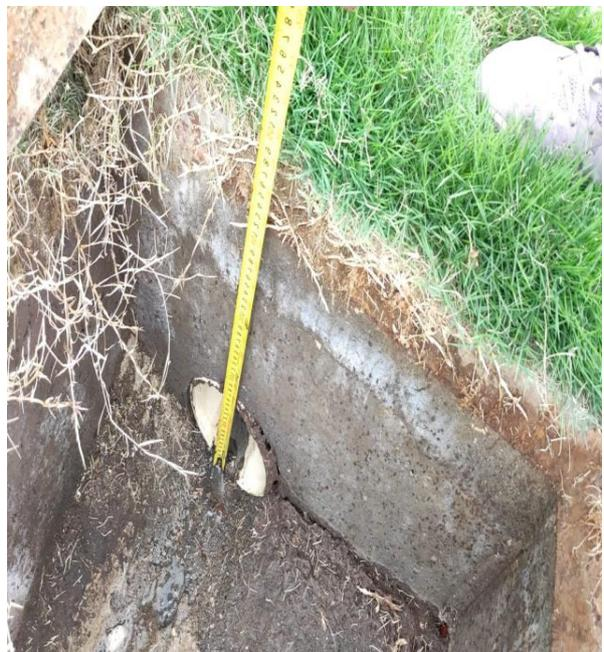
*Ilustración 54: Medición de diámetros de tuberías*
