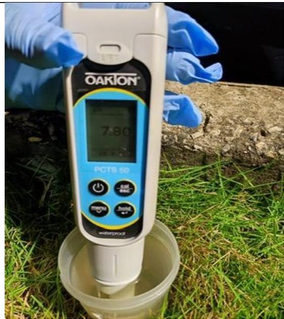
*Ilustración 28: Medición en Sitio-pH- Oakton PCTSTestr™ 50*
