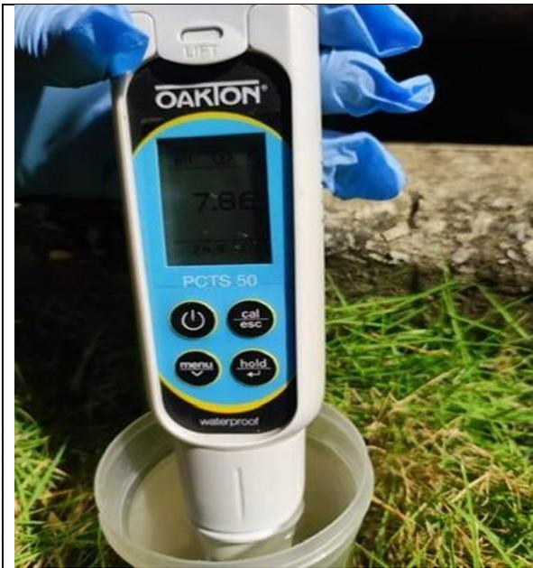
*Ilustración 27: Medición en Sitio-pH-Multiparámetro Oakton PCTSTestr™ 50*
