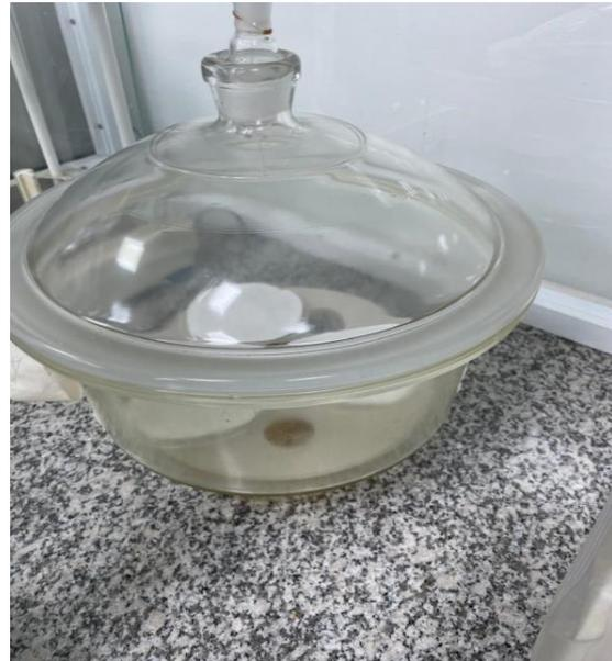
*Ilustración 11: Muestra en el desecador por 15 minutos*
