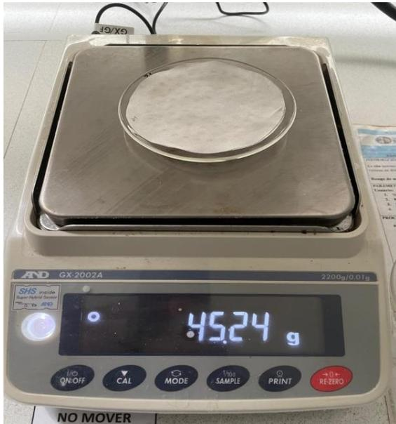
*Ilustración 14 Peso de muestra en papel filtro y vidrio reloj*
