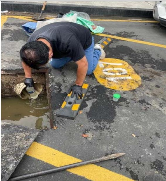
*Ilustración 33: Recolección de muestras para DBO-DQO-Aceites y Grasas- Sulfuros*
