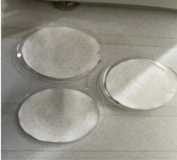
*Ilustración 12: Muestras salidas del horno en el papel filtro – 1 hora después*
