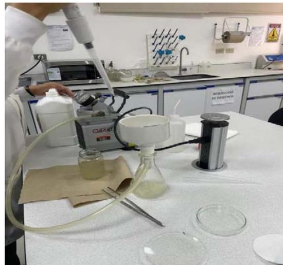
Ilustración 17: Filtrado de la muestra al vacío
