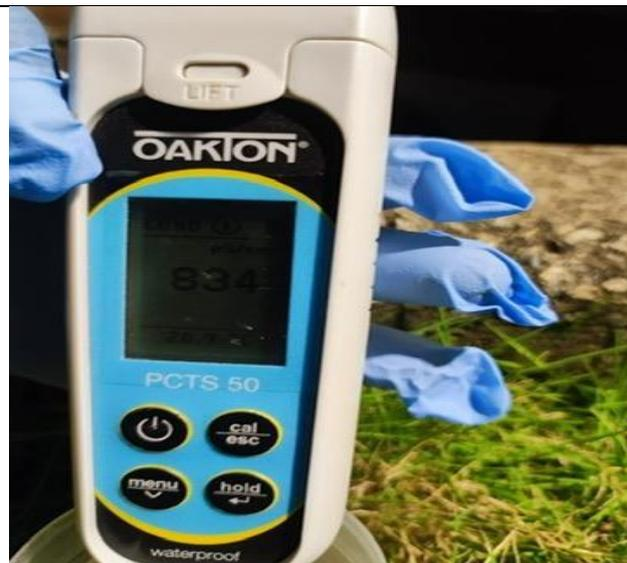
*Ilustración 29: Medición en Sitio-pH-Multiparámetro Oakton PCTSTestr™ 50*
