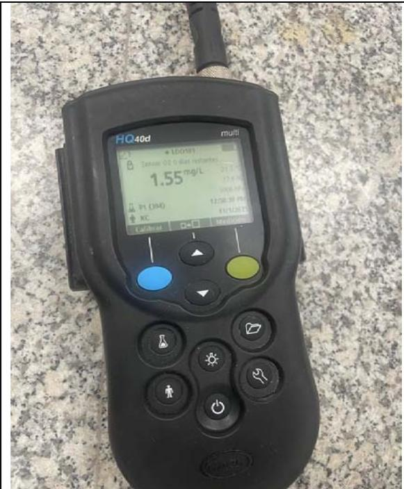
Ilustración 25: Medición de OD
