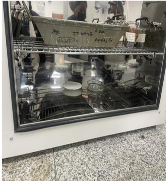
*Ilustración 10: Ingreso de la muestra al horno a 105 C*
