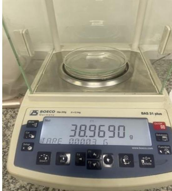
*Ilustración 8: Peso del vidrio reloj en la balanza analítica*
