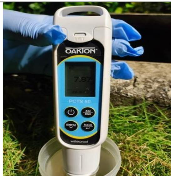
*Ilustración 30: Medición en Sitio-pH-Multiparámetro Oakton PCTSTestr™ 50*
