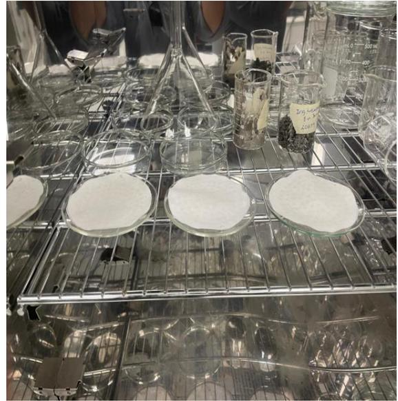
Ilustración 16 Muestras ingresadas al Horno
