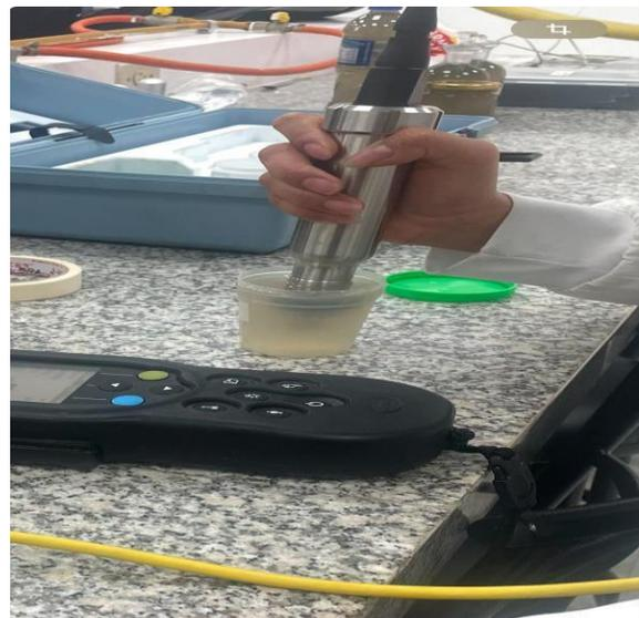
Ilustración 26: Medición del OD en Laboratorio
