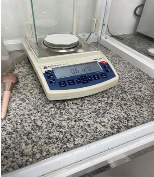
*Ilustración 7: Peso del papel filtro en la balanza analítica*
