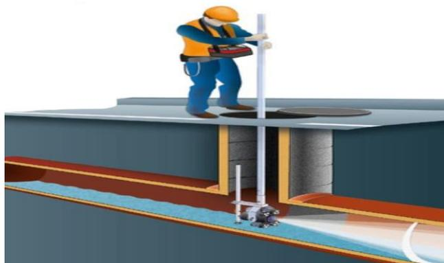
*Nota.* Imagen obtenida de internet, donde se puede apreciar un pozo de inspección.
