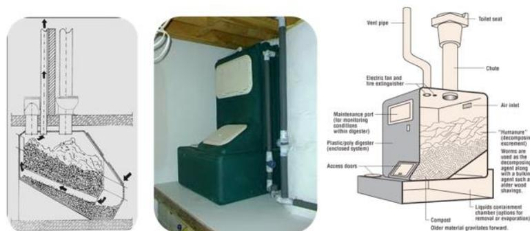
Ilustración 16. Sistema de compostaje seco modelo Clivus Multrum
