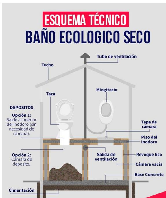
Ilustración 12. Mecanismo sistema de compostaje seco
