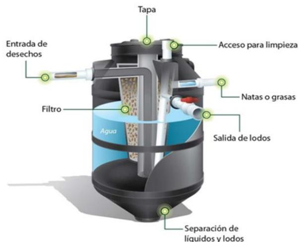
*Ilustración 10. Partes de un biodigestor.*
