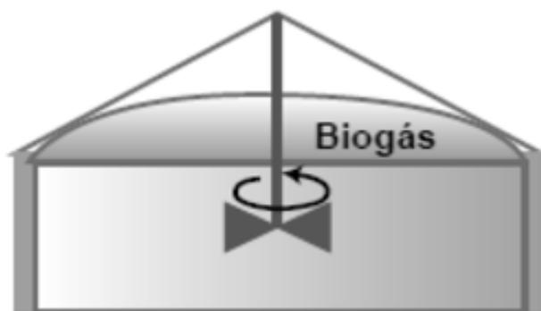
*Ilustración 8. Biodigestor de Mezcla Completa*
