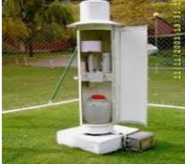
Ilustración 14. Pluviógrafo
