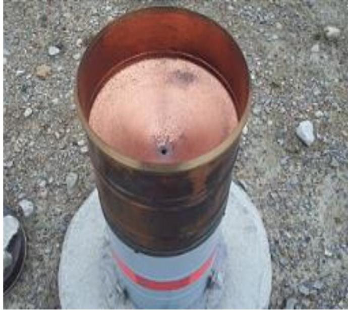
Ilustración 13. Pluviómetro
