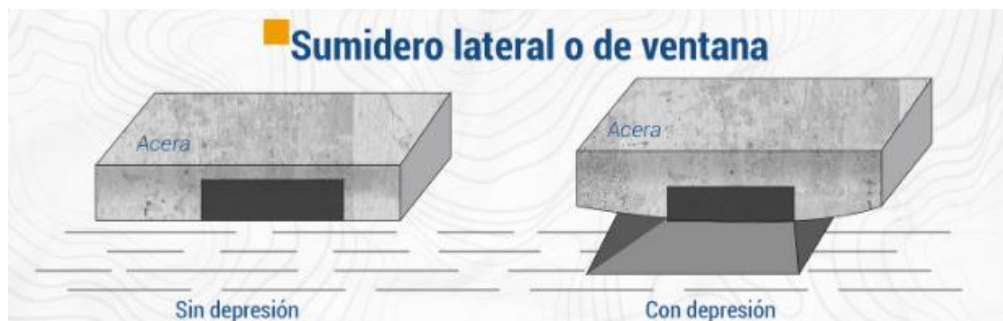
Figura 2 Sumideros de ventana
