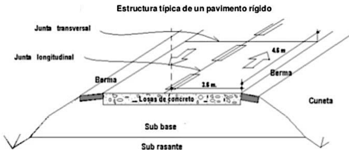
Ilustración 5 Estructura típica de un pavimento rígido
