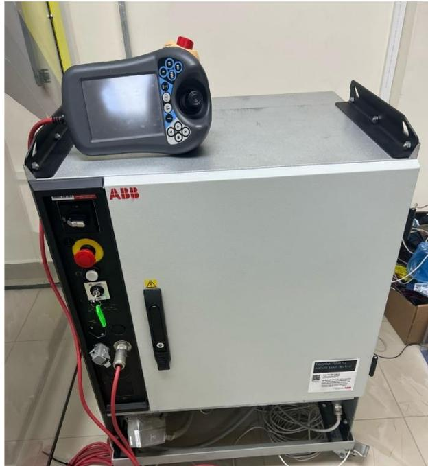
Al encender el controlador, el FlexPendant iniciará “RobotWare”, éste es el sistema operativo desarrollado por ABB para sus robots industriales, encargado de gestionar la ejecución de programas, la comunicación con periféricos y la interacción con el usuario a través del FlexPendant, en la siguiente imagen se visualiza la interfaz inicial del mismo, figura 92.
