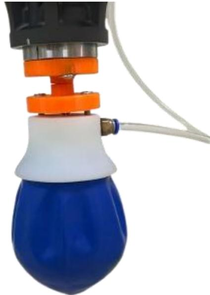
El control del gripper se integró con un tablero de control neumático preexistente en el laboratorio como se presenta en la figura 55, encargado de gestionar la presión, carga y descarga de aire, para ello, se realizó la conexión neumática y eléctrica. Este sistema brindará los parámetros específicos de presión de aire para regular la fuerza de sujeción y evitar daños en las frutillas, asegurando el correcto funcionamiento del proceso de pick and place.
