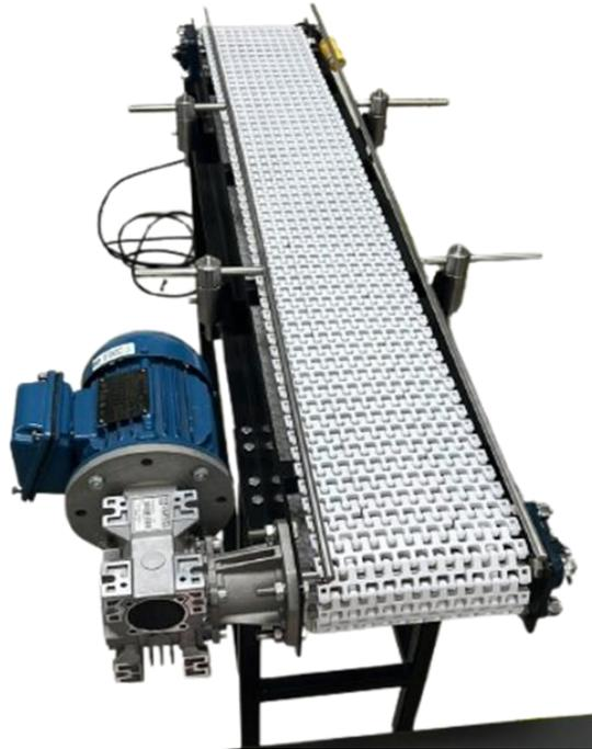
La configuración del motor usada es el tipo Delta  $\Delta$  la cual permite que la banda tenga un torque adecuado y un arranque más robusto. En la siguiente figura 18 se contempla la configuración con su alimentación trifásica, dejando la banda para su uso.
