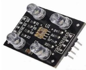
*Nota.* Imagen de un sensor de color **TCS3200**, utilizado para la detección y diferenciación de colores en aplicaciones de automatización y robótica. Funciona mediante una matriz de fotodiodos y un generador de frecuencia configurable (Novatronic, 2020).
