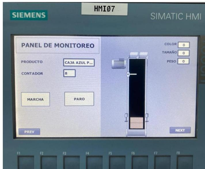
El sistema realiza una evaluación lógica y determina si el objeto debe ser aceptado o rechazado. Esta decisión es tomada con base en reglas programadas en el software del PLC, el cual genera una señal de control para el servomotor encargado de la clasificación.
