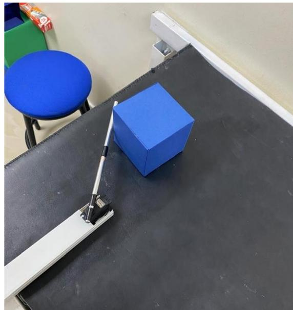
Esta prueba permitió comprobar el correcto funcionamiento del sistema de clasificación, asegurando que el servomotor ejecuta la tarea de desplazamiento de manera correcta y con la fuerza adecuada para modificar la ubicación del objeto sin generar inestabilidad en la estructura.
