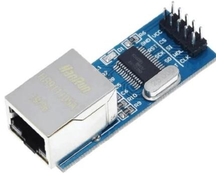
*Nota.* Imagen de un módulo Ethernet ENC28J60, utilizado para la comunicación del Arduino al PLC por Modbus en el sistema de clasificación de cajas. Este módulo permite la conexión de Arduino a redes Ethernet mediante una interfaz SPI (Robotics, 2023).
