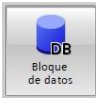
*Nota.* La imagen representa un Bloque de Datos (DB) en TIA Portal, utilizado para almacenar los datos recibidos de los sensores por el protocolo Modbus TCP/IP. Estos bloques optimizan la organización ya que pueden usarse en cualquier línea de código (Siemens, 2025).
