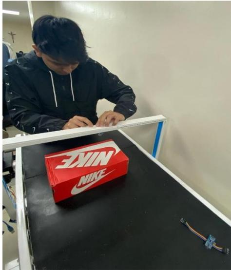
En las primeras pruebas, se intentó colocar el sensor en una posición estratégica de 90° y pegado a la canaleta para que permitiera la detección de las cajas. Sin embargo, se observaron dificultades en la estabilidad del montaje, lo que generaba mediciones inconsistentes porque el pegamento no era muy bueno para sostener el sensor. Se realizaron ajustes en la estructura de soporte donde en vez de pegar el sensor, se coloca dentro de la canaleta y su detección sale por medio de una abertura.
