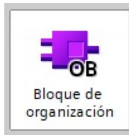
*Nota.* La imagen muestra un Bloque de Organización (OB) en TIA Portal, utilizado para gestionar la ejecución del programa en un PLC Siemens. El OB1 es el principal, y otros OB manejan eventos o interrupciones específicas. (Siemens, 2025)
