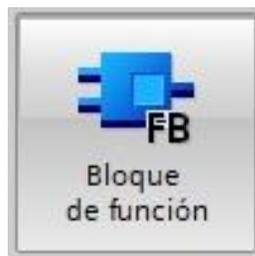
*Nota.* La imagen muestra un Bloque de Función (FB) en TIA Portal, utilizado para ejecutar tareas específicas dentro de un PLC Siemens. Este bloque cuenta con un DB de instancia que almacena datos exclusivos en cada llamada (Siemens, 2025).
