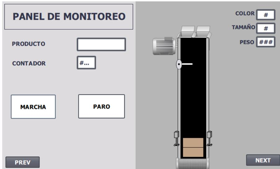
A la derecha se observa una representación gráfica del sistema de clasificación, incluyendo una banda transportadora y un servomotor para desviar el producto según su categoría y en la esquina se ve el color, peso y tamaño requerido.
