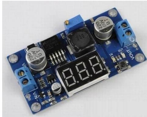
*Nota.* Módulo regulador step-down LM2596 con display de 7 segmentos para controlar el voltaje enviado al servomotor utilizado para la clasificación (ArduMótica, 2023).
