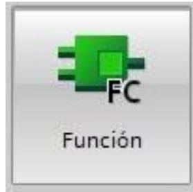
*Nota.* La imagen representa un Bloque de Función (FC) en TIA Portal, utilizado para ejecutar operaciones específicas sin requerir un DB de instancia. Estos bloques optimizan la organización del programa en un PLC Siemens (Siemens, 2025).
