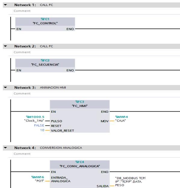
El bloque FC\_CONTROL se encarga del mando de la operación, el cual cuenta con bloque SR (Set-Reset) para la activación y desactivación del modo automático. Además, este modo automático comanda el estado en el que las salidas que intervienen en el proceso actúan tal y como se evidencia en la figura 51.
