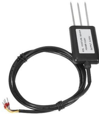
Nota. En la imagen se observa el sensor de temperatura y humedad RK520-01. Tomado de: (Orellana, 2024)
