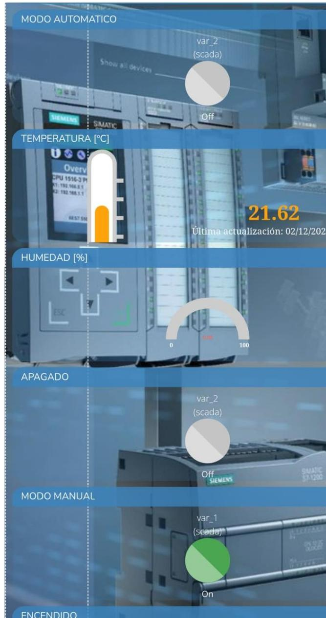
*Nota.* En la imagen se tiene la aplicación móvil la cual permite tomar los valores en tiempo real de la temperatura y humedad a la que se encuentra el suelo. Tomado de: Fuente propia
