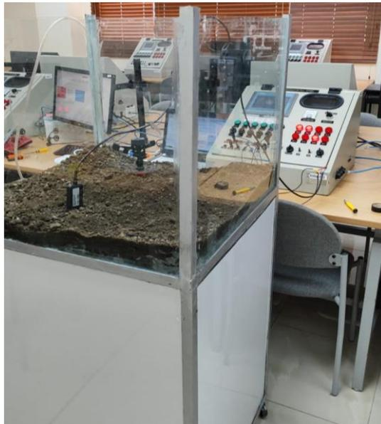
*Nota.* En la imagen se observa el prototipo que se va a utilizar para realizar pruebas del sistema de riego automático de un potrero.
