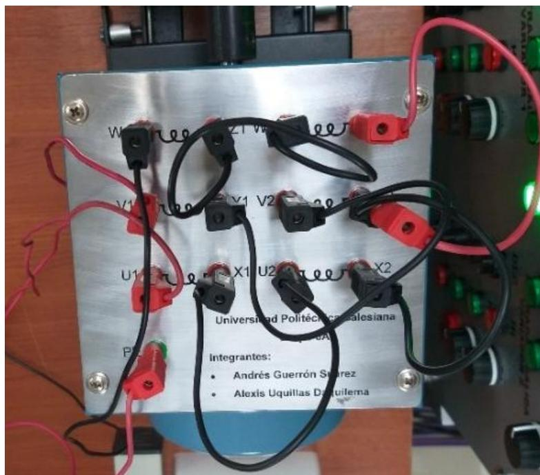
*Nota.* Conexión estrella-serie para el arranque del motor trifásico, adaptándose a la configuración del variador.
