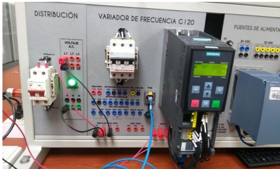
*Nota.* La figura muestra un sistema de distribución de dos líneas, utilizadas para la alimentación del Variador de Frecuencia G120
