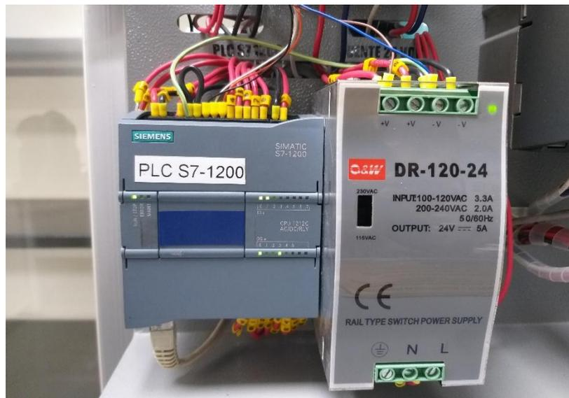
*Nota.* Uso del PLC S71200 con una fuente de 24v DC, necesaria para la conexión del encoder incremental.
