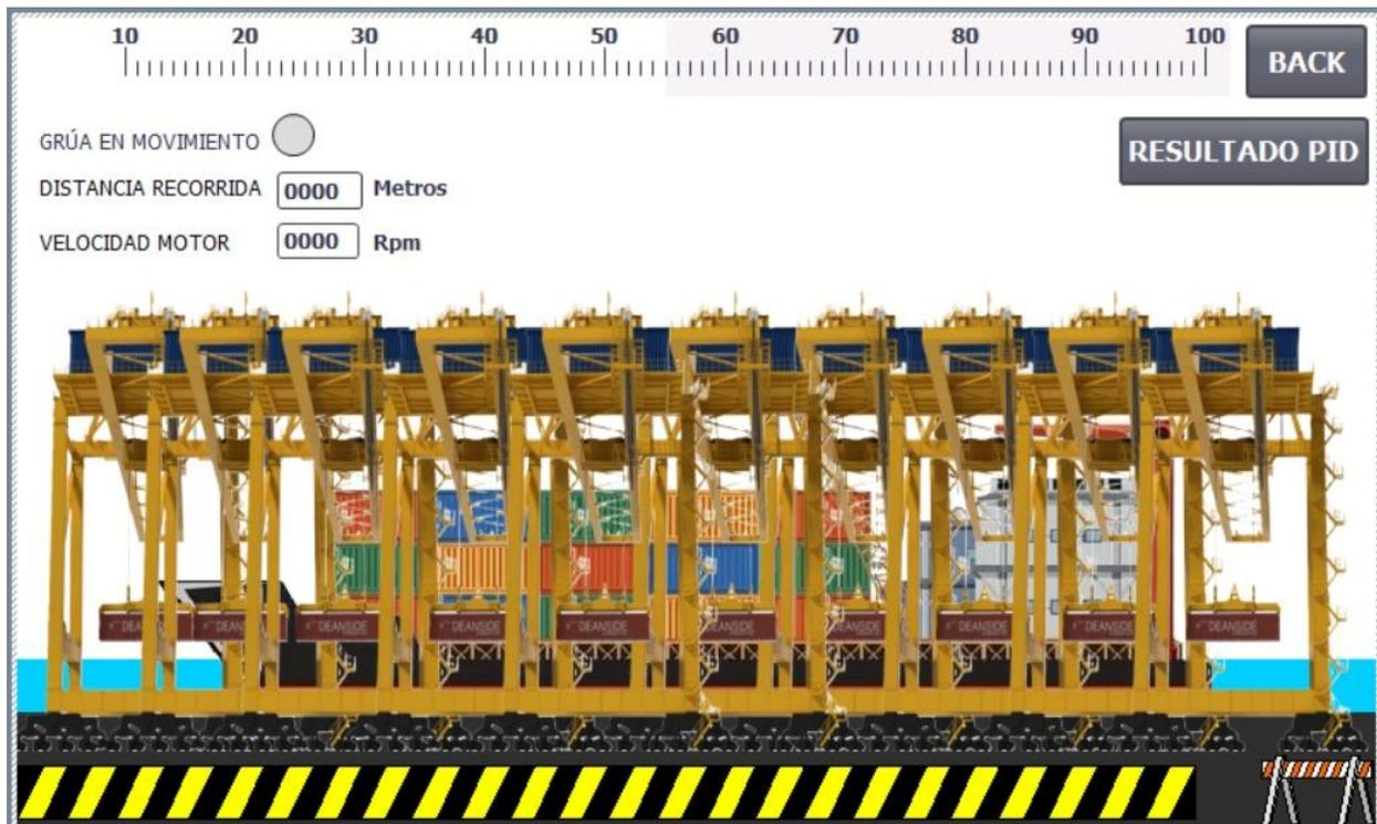
*Nota.* Interfaz gráfica de simulación del movimiento gantry en una grúa STS, con indicadores de distancia y velocidad.
