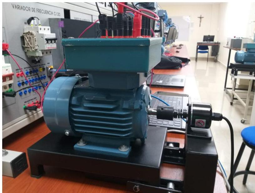
*Nota.* la imagen muestra una estructura de acoplamiento flexible entre el eje del motor y el eje del encoder incremental.
