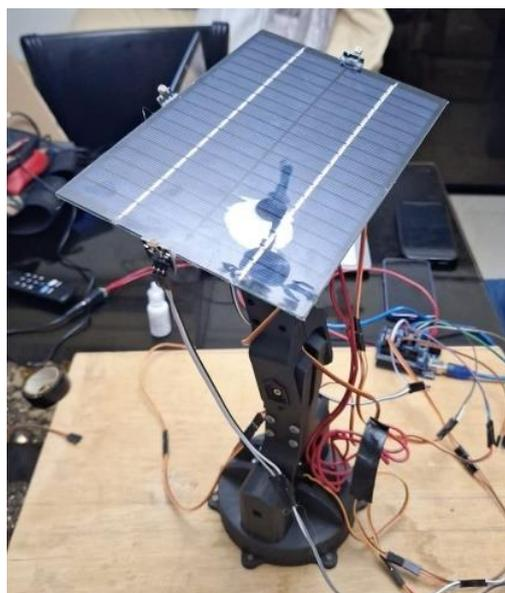
*Nota.* Ensamblaje del panel a la muñeca del prototipo del brazo robótico.
