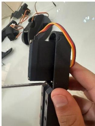
*Nota.* Ensamblaje del siguiente servomotor al eje del codo.
