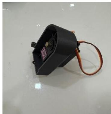
*Nota.* Ensamblaje de la impresión del hombro en 3D con el servomotor MG996R.
