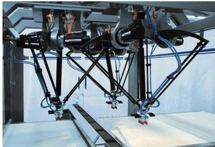
*Nota.* Se observa dos robots deltas haciendo un trabajo en la línea de ensamble (Peña m. , 2021).
