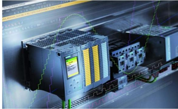
*Nota:* El PLC Siemens S7-1500 proporciona tiempos de respuesta rápidos gracias a su capacidad de procesamiento de hasta 1 nanosegundo y a su interfaz PROFINET. Fuente: (SIEMENS, 2025)
