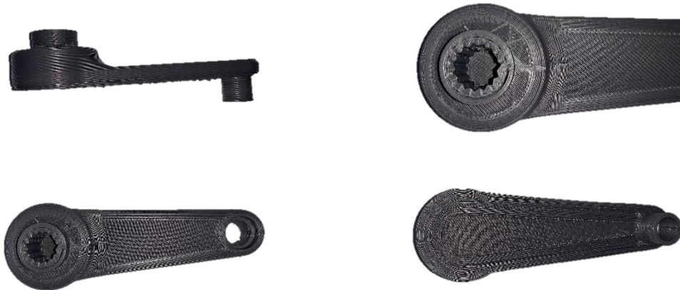
Figura 47. Comparaciones de dimensiones de la manivela.
