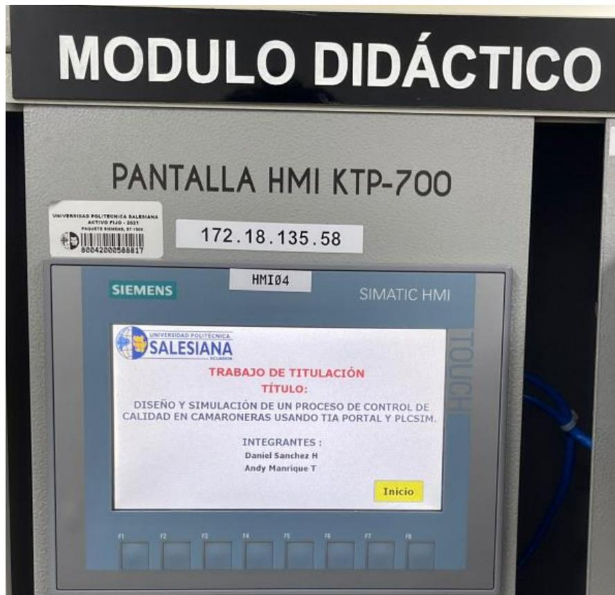
*Figura 2. HMI KTP 700 del laboratorio de automatización 2 de UPS-GYE.*
