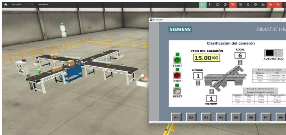
**Figura 15. Simulación de la clasificación de camarones mediante Factory IO.**
