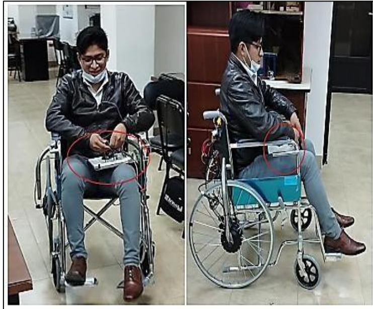
Figura 1 Silla de ruedas con propulsión y control automático
