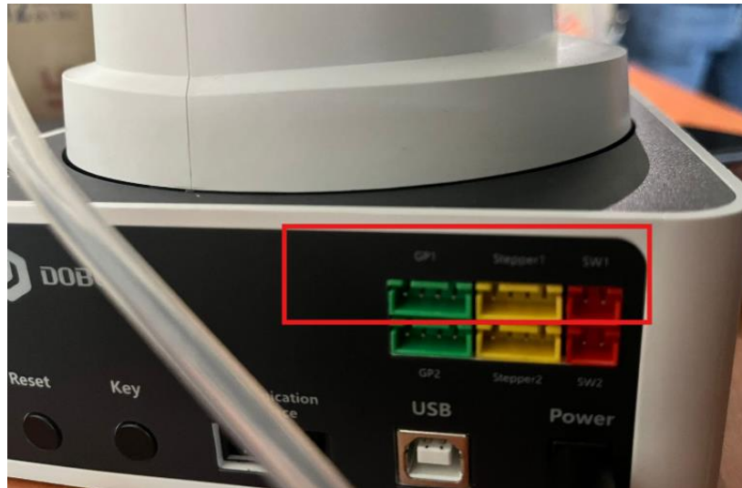
Figura 18 Conexión de la bomba de aire.
