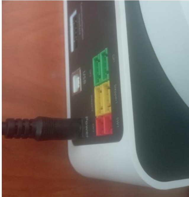
Figura 12 Conexión al puerto de entrada de voltaje.
