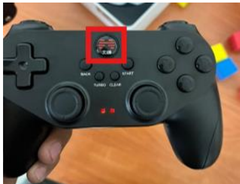
Figura 3 Encender el mando para realizar conexión con el robot Dobot Magician.
