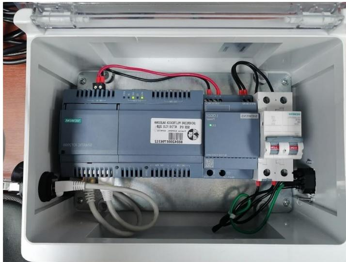
También se presenta una fotografía que muestra el estado del **PLC** en modo **RUN**, indicando que el programa ha sido cargado correctamente y se encuentra en ejecución, figura 163.
