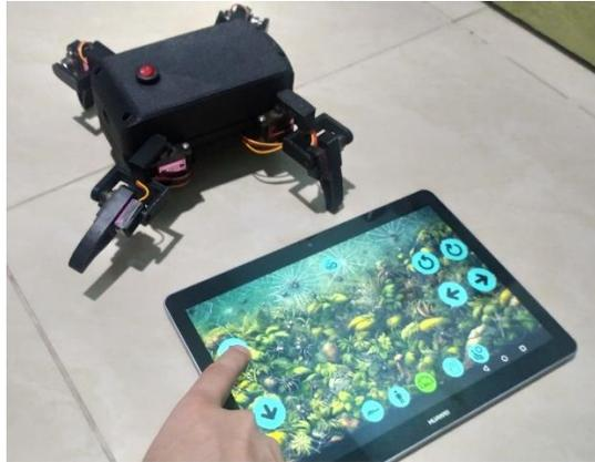
También se comprobó que funcionamiento cuando se realiza el cambio de modo manual a autónomo y viceversa, como se muestra en la figura 149. Durante la prueba, el robot funcionó aproximadamente 30 minutos, y después de ese tiempo, la batería (LiPo) aún tenía un 60% de carga. Esto sugiere que el robot podría operar alrededor de 1 hora y 15 minutos (aproximadamente) antes de agotar por completo la batería.
