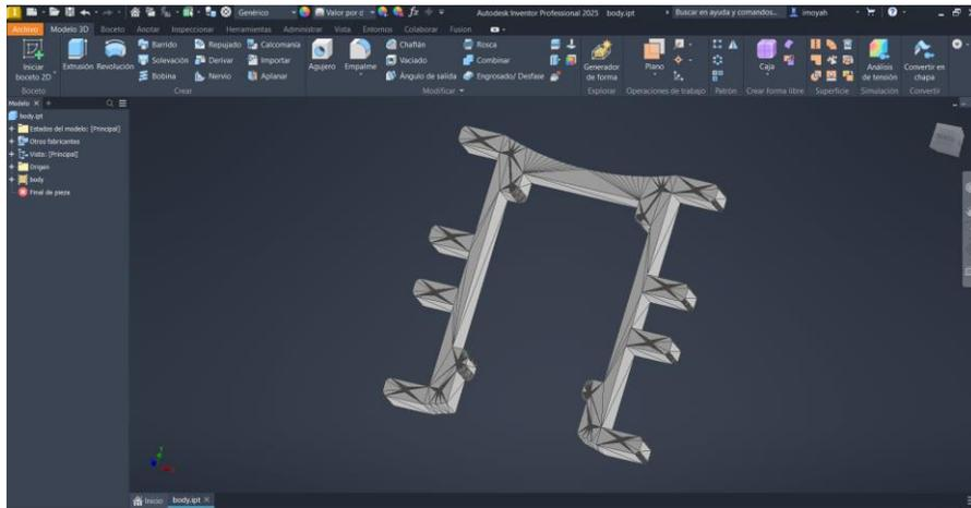
Para el diseño propio, se incrementaron dichas medidas a 14.1 cm de largo, 9.7 cm de ancho y se mantuvo el grosor de 1 cm, tal como se muestra en la figura 22. Se dejó un espacio adicional en la parte frontal para facilitar la conexión del cable de la cámara y otro espacio para alojar la batería, cuyas dimensiones son 6.7 cm de largo por 2.5 cm de ancho. Finalmente, también se habilitó un área para la tarjeta electrónica principal del robot. A los costados de la pieza, se
