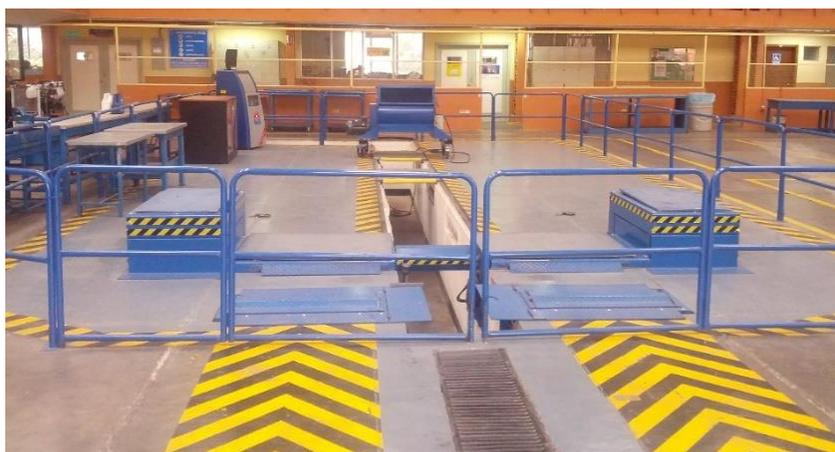
Figura 9: Banco dinamométrico
