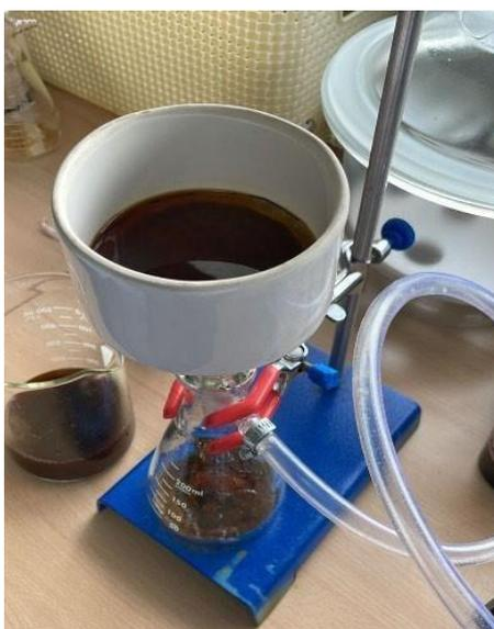
*Imagen 6. Proceso de filtración al vacío.*
