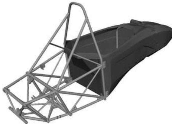
*Figura 3. Chasis. (s. f.). Diseño Automotriz UFT.*
