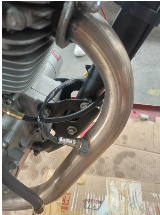
Figura 28. Sensor de oxígeno instalado
