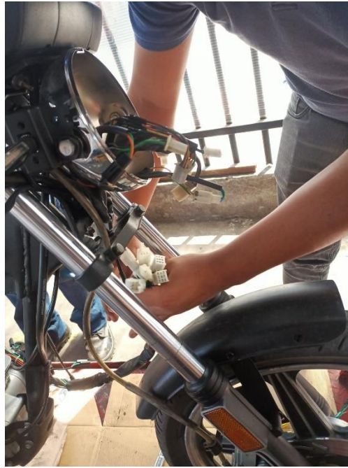
Figura 23. Desmontaje del ramal eléctrico
