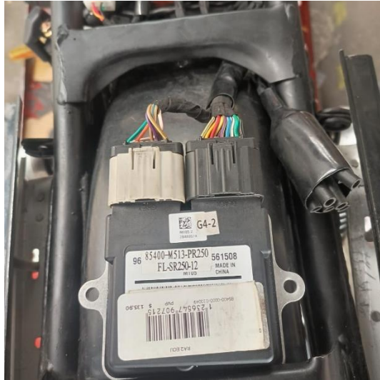
Figura 33. ECU empleado en el proyecto
