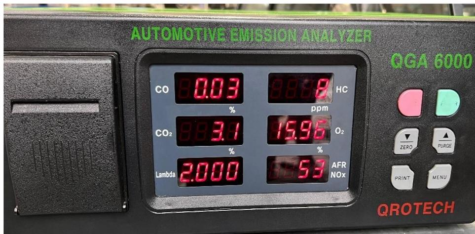
*Nota:* Emisiones de partida con el motor funcionando únicamente con diésel a 2500 rpm. Fuente: Autores
