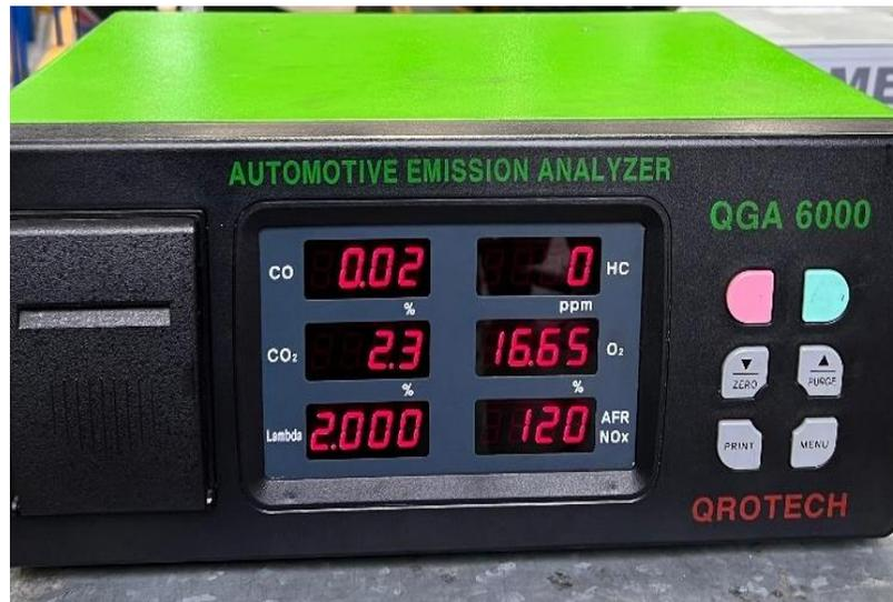
*Nota:* Emisiones de partida con el motor funcionando con 25% de hidrógeno. Fuente: Autores
