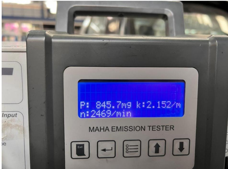
*Nota:* Datos del opacímetro cuando el motor está trabajando con una mezcla hidrógeno-diésel (50% y 50% respectivamente) a 2500 rpm. Fuente: Autores
