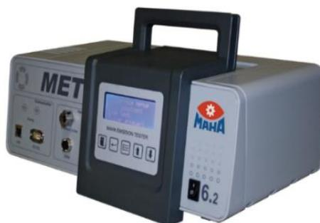
*Nota:* Instrumento de medición de opacidad, opacímetro. Fuente: Autores
