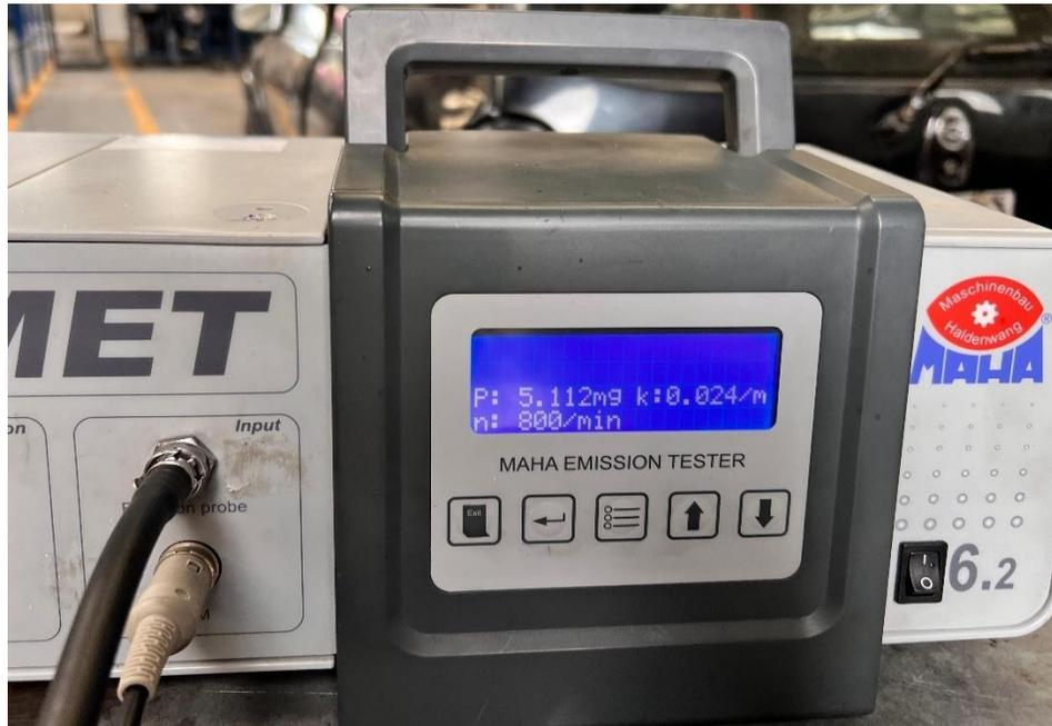
*Nota:* Datos del opacímetro cuando el motor está trabajando con una mezcla hidrógeno-diésel (50% y 50% respectivamente) en ralentí. Fuente: Autores
