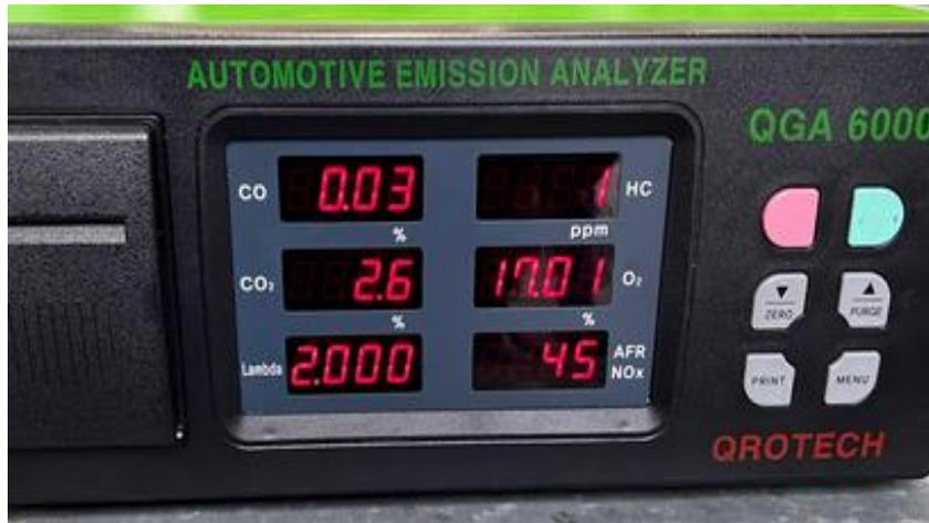
*Nota:* Emisiones de partida con el motor funcionando con 50% de hidrógeno a 2500 rpm. Fuente: Autores
