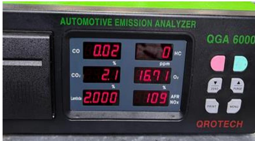
*Nota:* Emisiones de partida con el motor funcionando con 50% de hidrógeno a ralentí. Fuente: Autores
