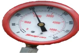
*Nota:* Compresión de 300 psi aproximadamente en general de los cilindros del motor diésel. Fuente
