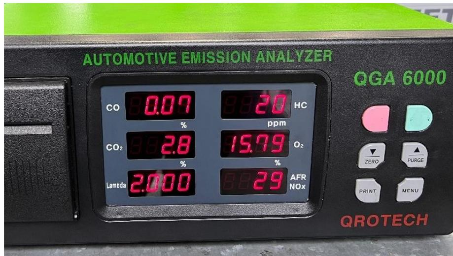
*Nota:* Emisiones de partida con el motor funcionando con 25% de hidrógeno a 2500 rpm. Fuente: Autores
