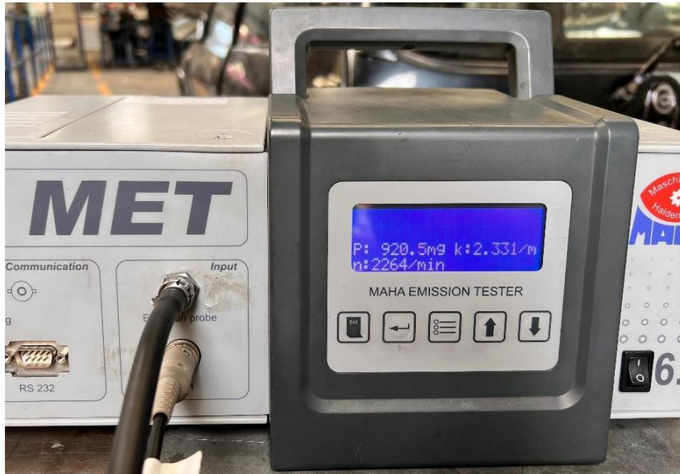
*Nota:* Datos del opacímetro cuando el motor está trabajando con una mezcla hidrógeno-diésel (25% y 75% respectivamente) a 2500 rpm. Fuente: Autores
