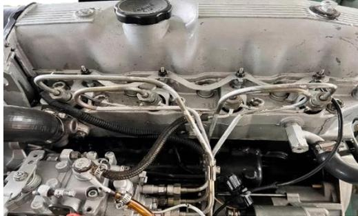
*Nota:* Revisión de las mangueras y tuberías de alta presión de combustible ubicadas en el motor.
