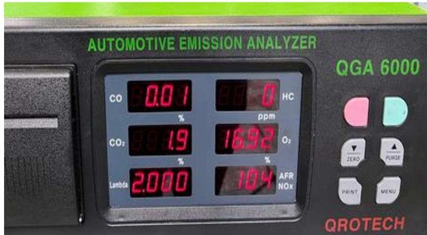
*Nota:* Emisiones de partida con el motor funcionando con 75% de hidrógeno. Fuente: Autores
