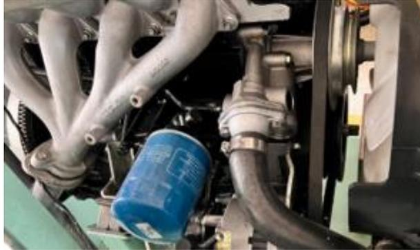
*Nota:* En la imagen se observa el filtro de aceite del motor al momento de efectuar su inspección, el cual no presentaba fugas de lubricante, ni deterioros en su estructura. Fuente: Autores
