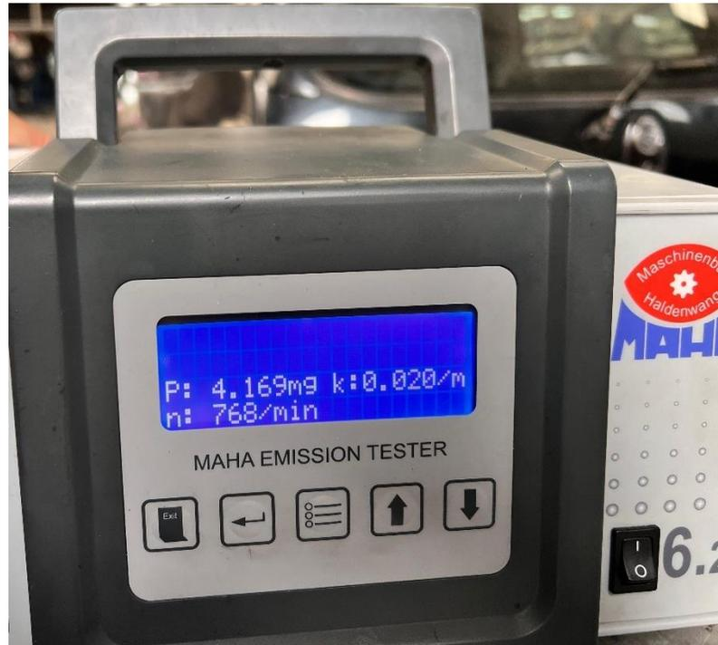
*Nota:* Datos del opacímetro cuando el motor está trabajando con una mezcla hidrógeno-diésel (75% y 25% respectivamente) en ralentí. Fuente: Autores
