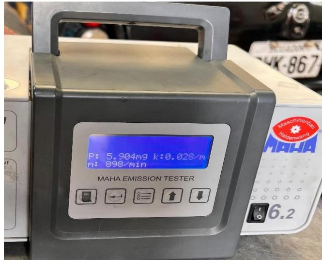
Nota: Datos del opacímetro cuando el motor está trabajando con una mezcla hidrógeno-diésel (25% y 75% respectivamente) en ralentí. Fuente: Autores
