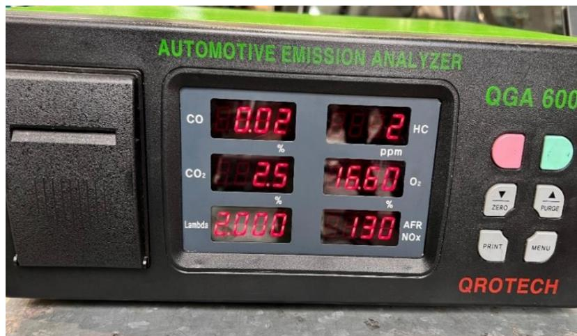
*Nota:* Emisiones de partida con el motor funcionando únicamente con diésel en ralentí. Fuente: Autores
