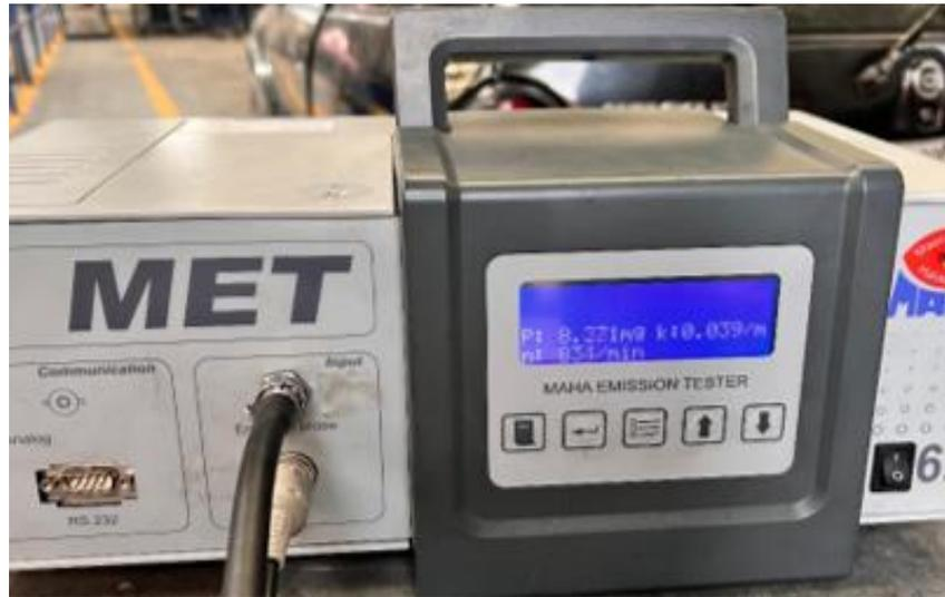
Nota: Datos del opacímetro cuando el motor está trabajando netamente con diésel en ralentí.
