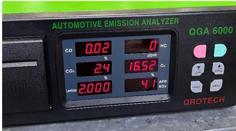
*Nota:* Emisiones de partida con el motor funcionando con 75% de hidrógeno a 2500 rpm. Fuente: Autores
