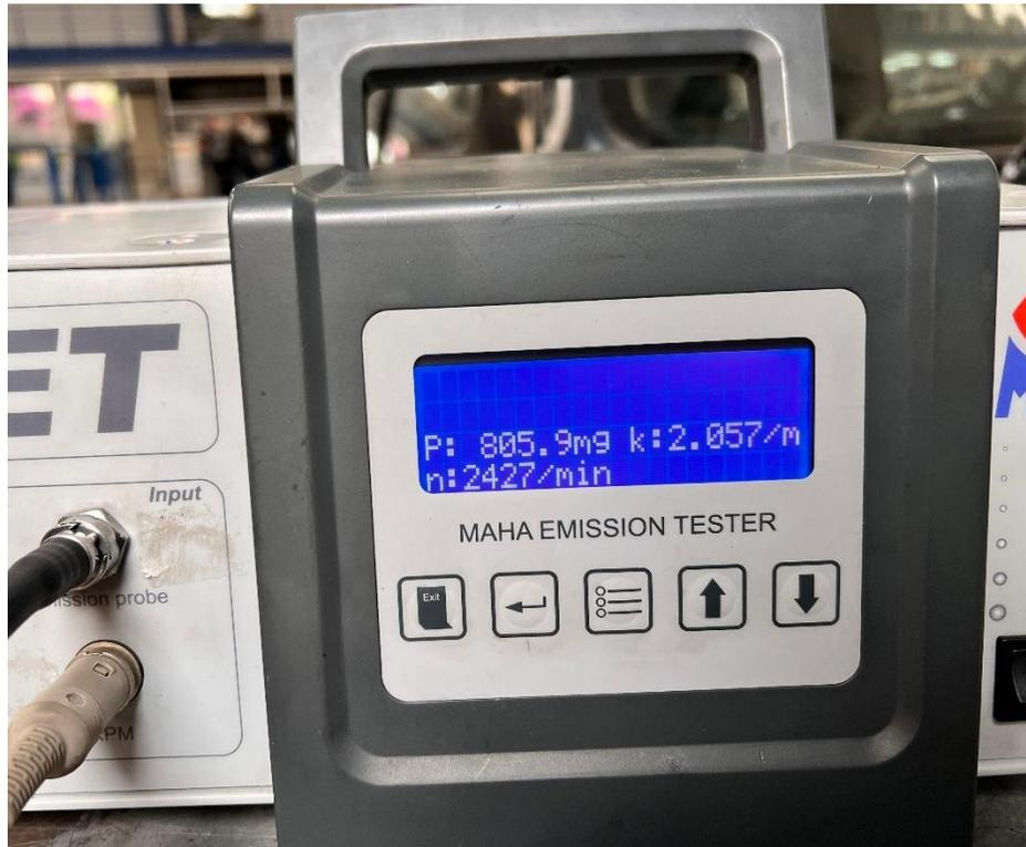
*Nota:* Datos del opacímetro cuando el motor está trabajando con una mezcla hidrógeno-diésel (75% y 25% respectivamente) a 2500 rpm. Fuente: Autores
