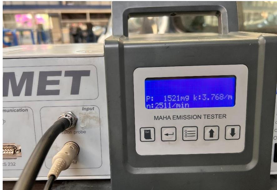
Nota: Datos del opacímetro cuando el motor está trabajando netamente con diésel a 2500 rpm.
