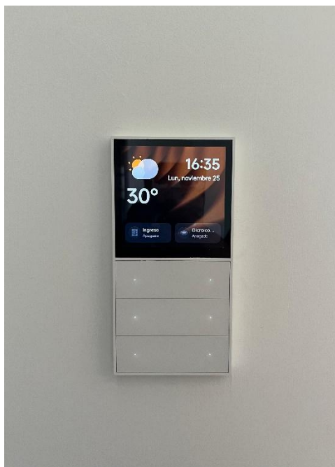
Figura 6 Pantalla Hub de Automatización
