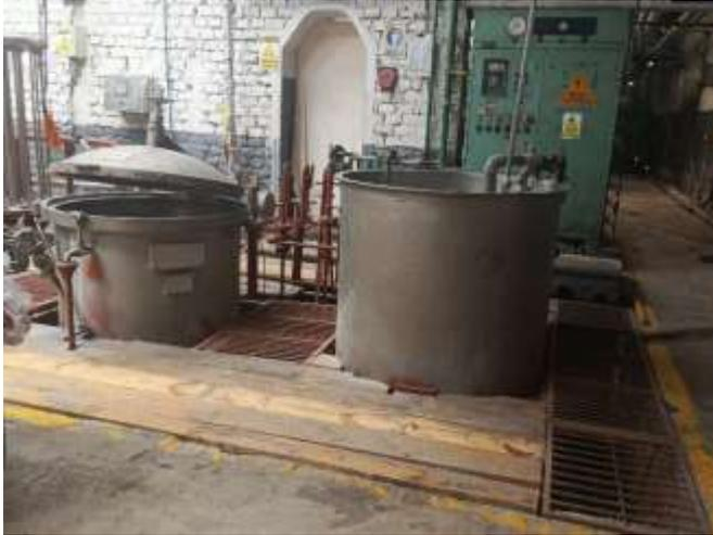
**Figura 48** Máquina autoclave
