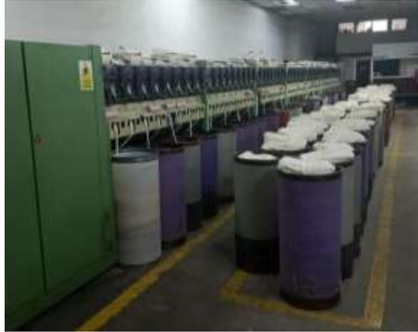
**Figura 30** Máquina Open-end
