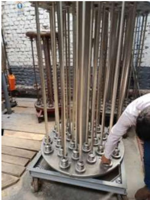
**Figura 46** Cargar hilo en máquina
