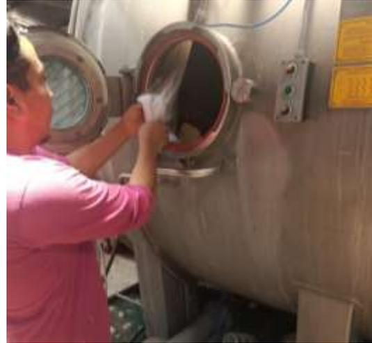
**Figura 49** Máquina overflow
