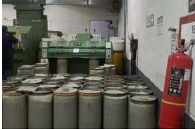
**Figura 28** Manuar de primer paso
