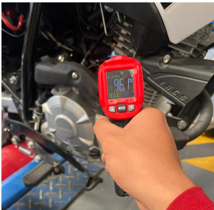
Nota: Monitoreo de la temperatura de funcionamiento del motor. Fuente: Autores.
