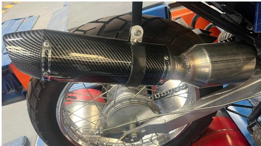
*Nota: Adaptación del mini convertidor catalítico en el sistema de escape de la motocicleta Yamaha XTZ 150: Tomado de Autores.*
