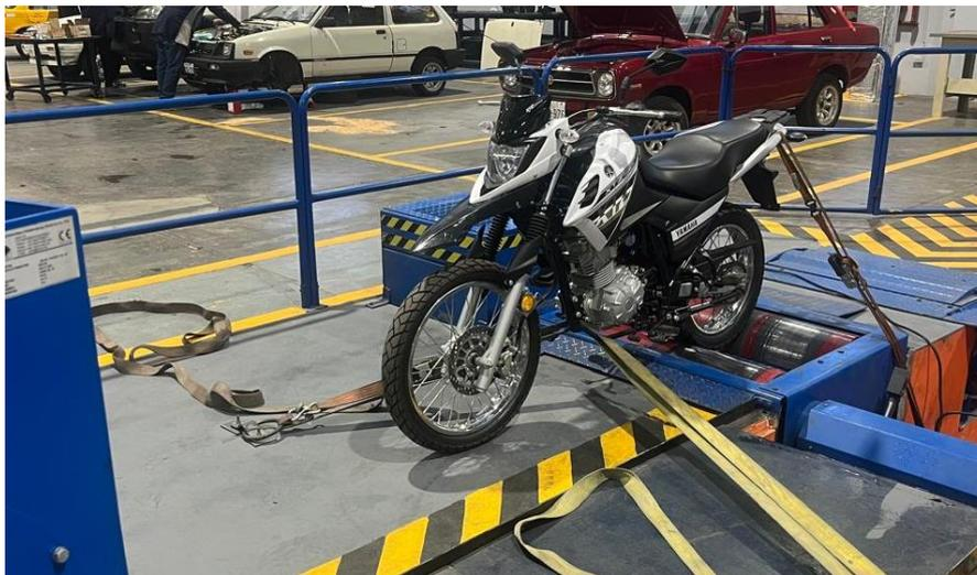
*Nota: Banco dinamométrico utilizado durante la adquisición de datos. Fuente: Autores.*
