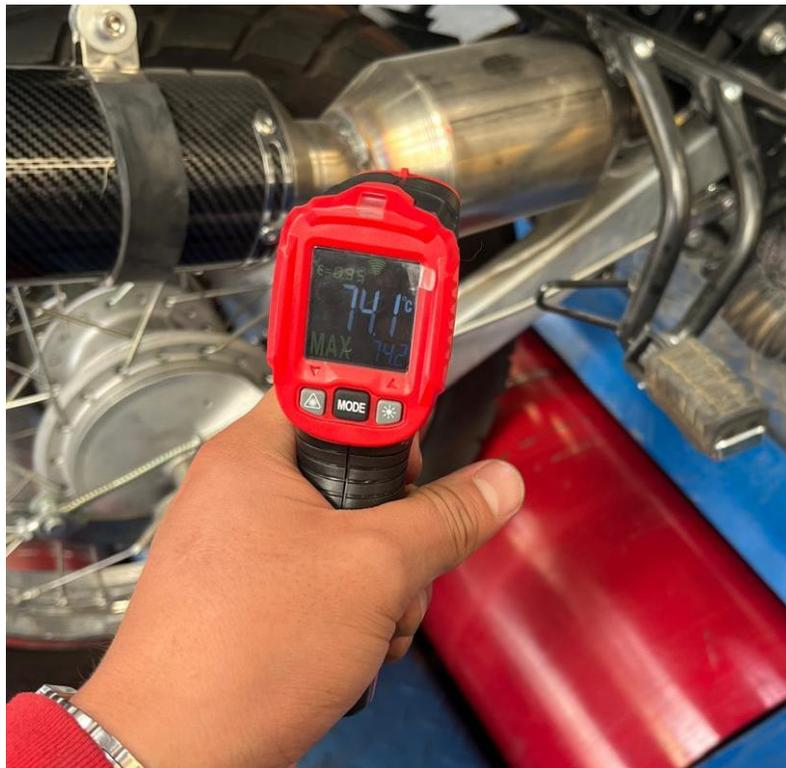
*Nota: Monitoreo de la temperatura del mini convertidor catalizador: Tomado de Autores.*
