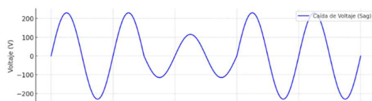
Figura 1. Caída de voltaje.
