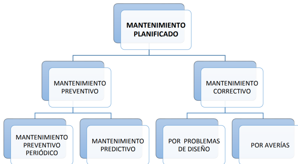
Figura 6. Clasificación Mantenimiento Planificado [13].
