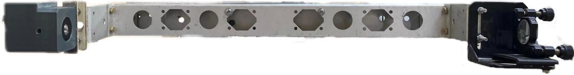
**Figura 2.27:** Estructura para interferometría con retroalimentación óptica para detección acústica
