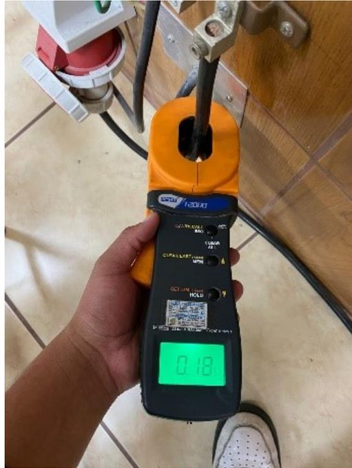
**Figura 2.18:** Medición de resistividad de la malla del Laboratorio de Alta Tensión
