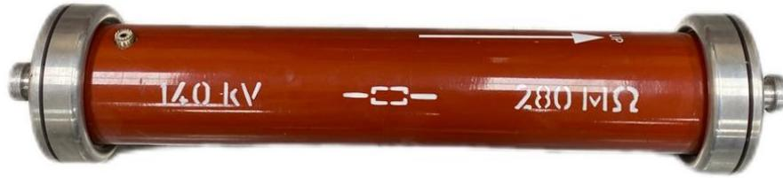
**Figura 2.13:** Resistor de Medida (HV 9113)
