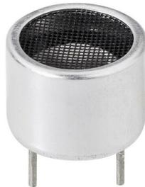
**Figura 2.26:** Transductor Ultrasónico
