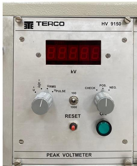
**Figura 2.6:** Voltímetro pico digital (HV 9150)
