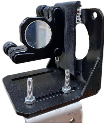
**Figura 2.25:** Espejo para rebote del Diodo Láser
