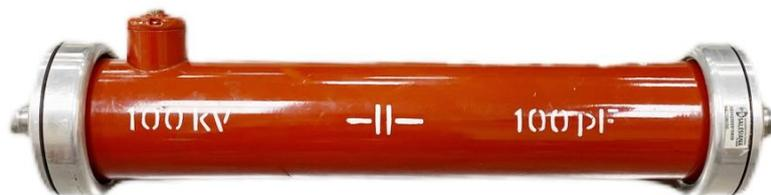
**Figura 2.7:** Capacitor de medida (HV 9141)
