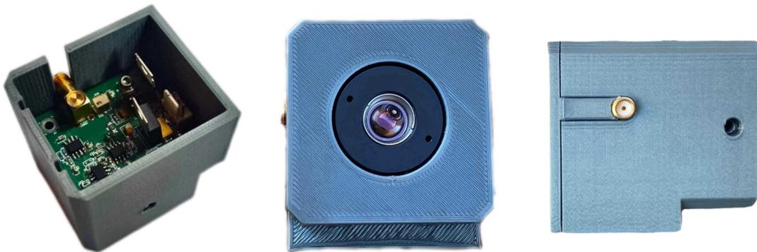
**Figura 2.58:** Protección al diodo láser mediante carcasa 3D
