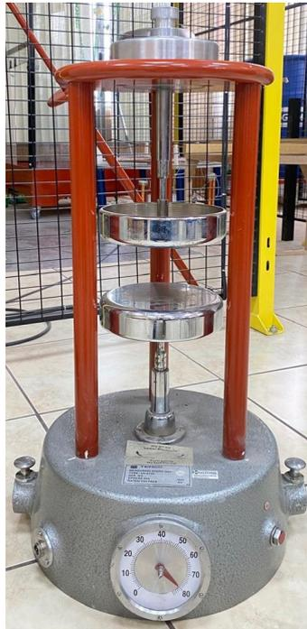
**Figura 2.16:** Medidor de distancia entre chispas (HV 9133)
