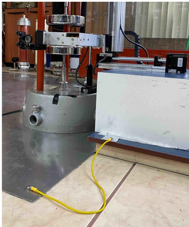
**Figura 2.62:** Aterramiento Estructura de Interferometría Óptica
