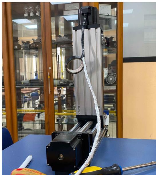
**Figura 2.60:** Protección de conductores de Motores de paso
