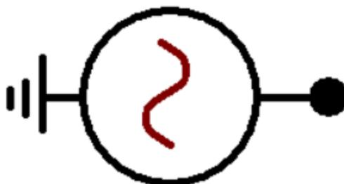
Figura 3.3: Fuente de Voltaje Alterno
