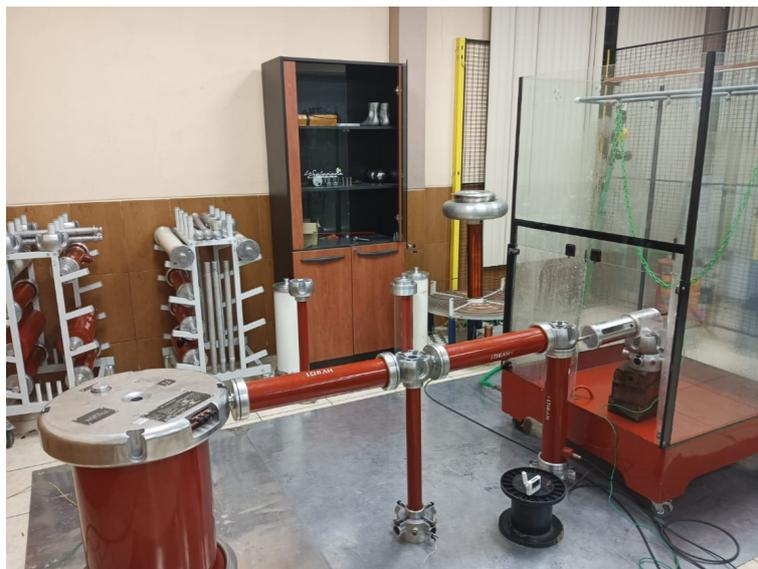
**Figura A.3:** Circuito experimental con cámara de lluvia
