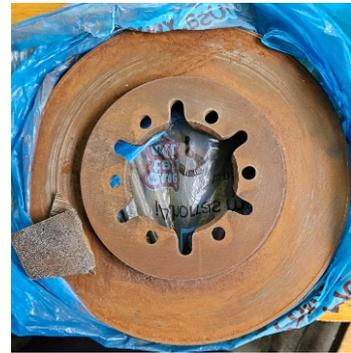
**Figura 6.** Disco oxidado para ser lijado
