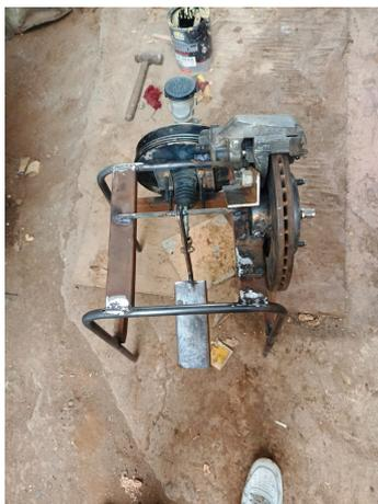
**Figura 5.** Estructura ya armada del sistema de frenos de disco
