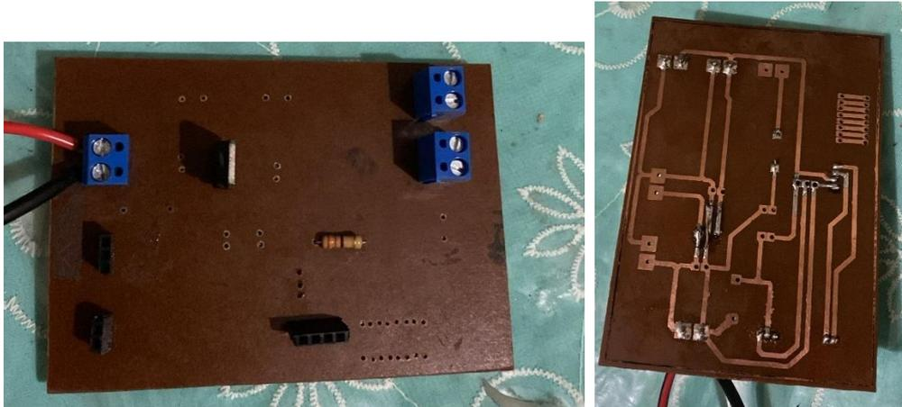
**Fig. 42.** Placa PCB construida del circuito de alimentación
