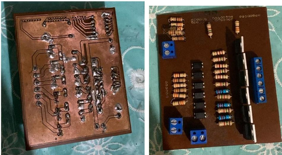
**Fig. 45.** Placa PCB construida del circuito de control
