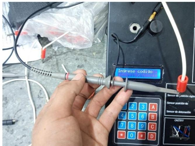
**Anexo 2.** Conexiones de la punta de prueba de osciloscopio
