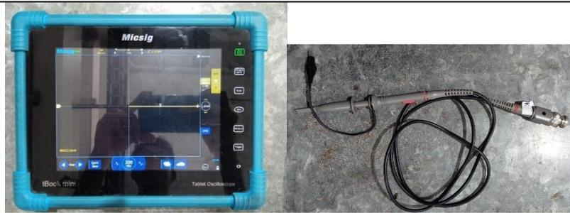
**Figura 7.** Uso de osciloscopio automotriz para obtener oscilogramas.
