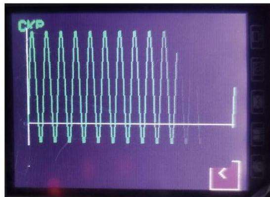
**Fig. 23.** Demostración de la onda en pantalla TFT (Señal del CKP Teórica).
