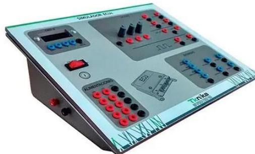
**Fig. 5.** Módulos de Simulador de ECU (NI sbRIO-9636). [14]
