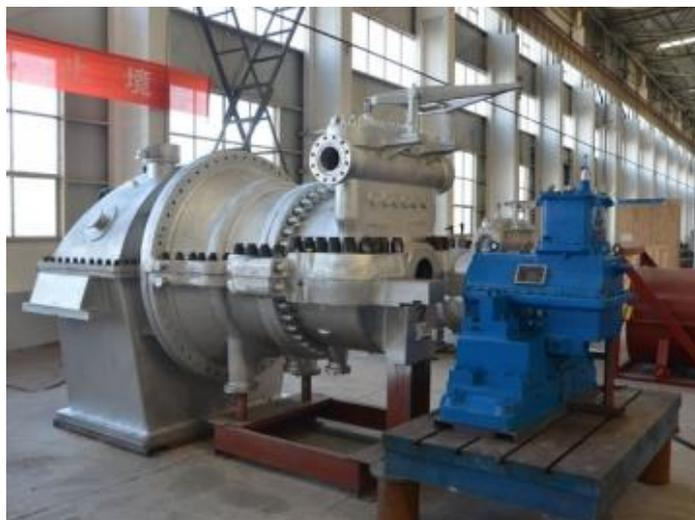
**Figura 20. Turbina de condensación.**
