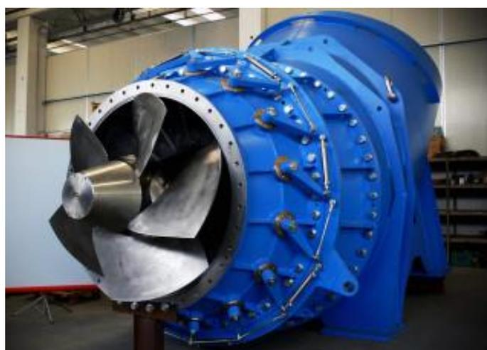
**Figura 19. Turbina de reacción.**
