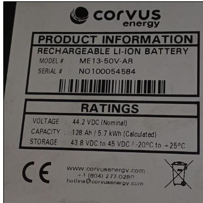
*Figura 27: Detalles de una batería Iones de litio NMC / grafito [53].*
