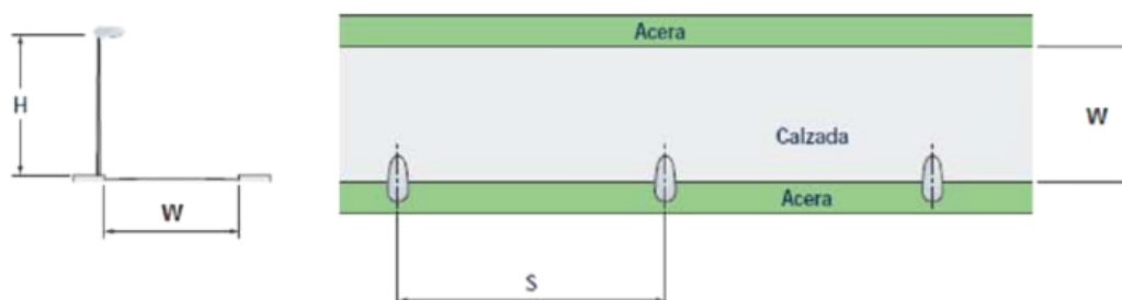
Figura 31: Luminarias de disposición unilateral.
