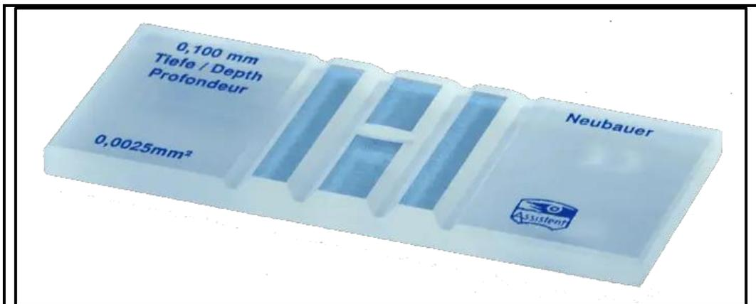
Figura 3 Cámara Neubauer con vista frontal
