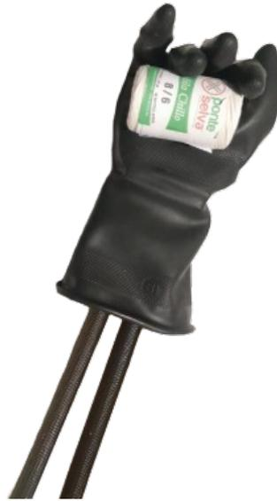
Figura 70. Prueba de agarre sobre un rollo de piola, Autor propio.
