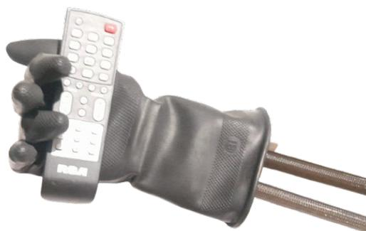
Figura 71. Prueba de agarre sobre un control remoto, Autor propio.
