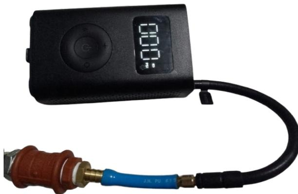
Figura 33. Acople a compresor, Autor propio.
