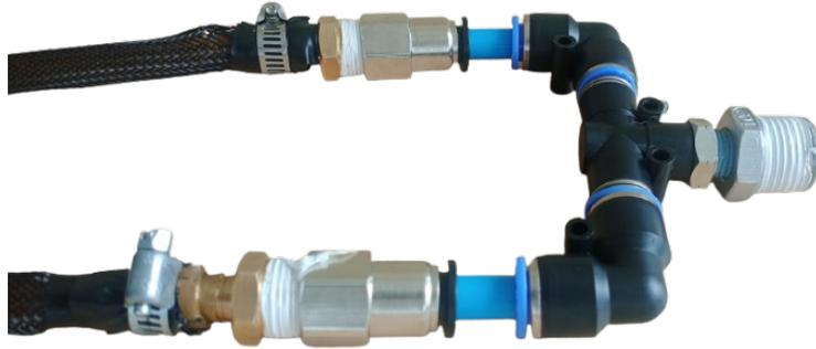
Figura 45. Acoples de paso de aire, Autor propio.
