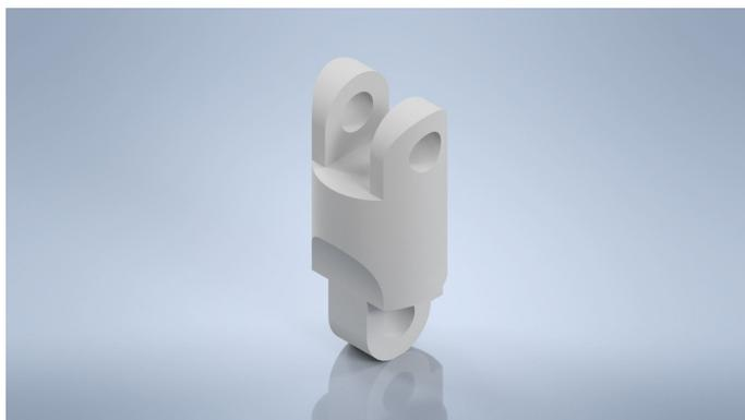
Figura 38. Diseño de las falanges medias, Autor propio.
