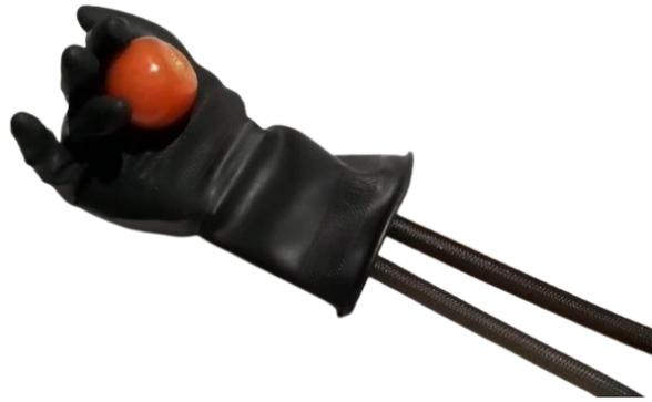
Figura 69. Prueba de agarre sobre un tomate, Autor propio.
