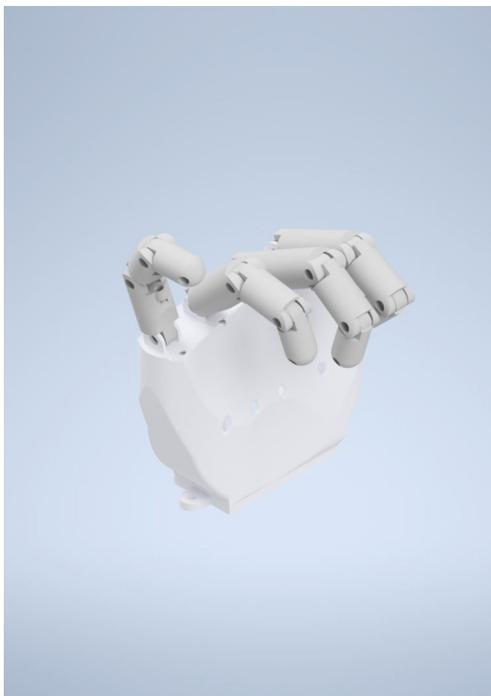
Figura 36. Unión del diseño de la palma con sus respectivas falanges, Autor propio.
