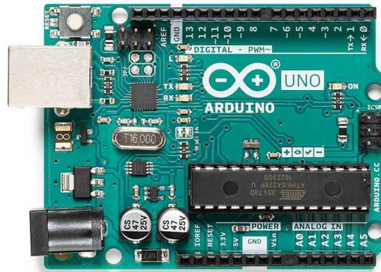
Figura 14. Microcontrolador Arduino Uno [30].
