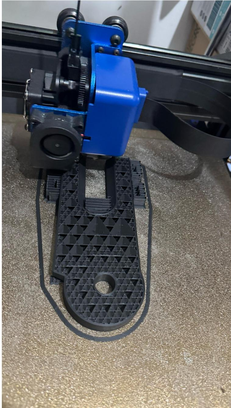
Figura 67. Proceso de impresión 3D del prototipo, Autor propio
