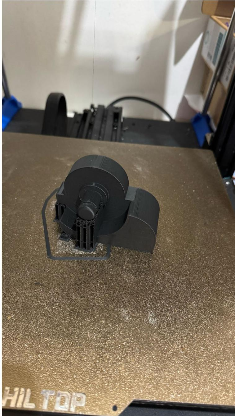
Figura 70. Proceso de impresión 3D del prototipo, Autor propio
