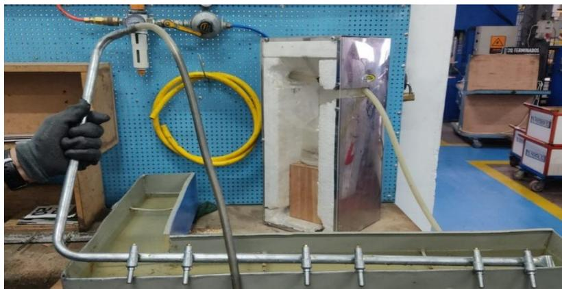
**Figura 19.** Control de fugas de GLP. **Fuente:** Autor.
