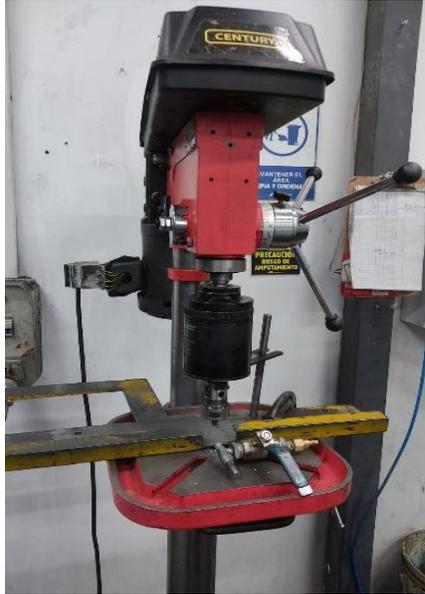
**Figura 1.** Taladro de pedestal con accionamiento manual. **Fuente:** Autor.
