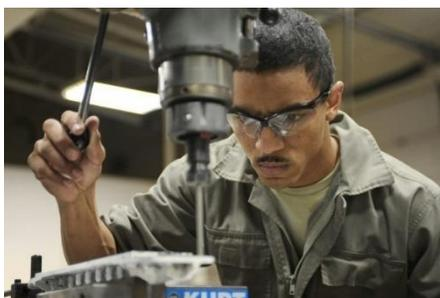
**Figura 7.** Operación en taladro de columna manual. **Fuente:** (Prevención, s.f.)
