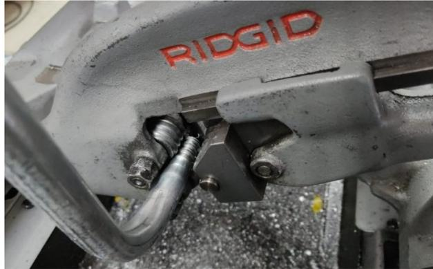
**Figura 12.** Estriado del tubo. **Fuente:** Autor.
