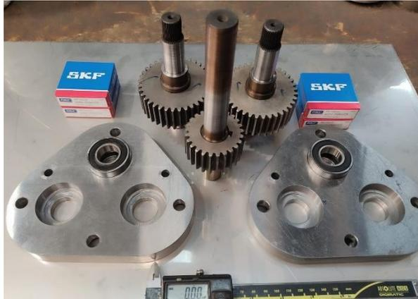
**Figura 34.**Eje de tracción secundario **Fuente:** Autor
