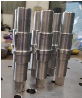
**Figura 31.** Eje de tracción de rotor. **Fuente:** Autor.
