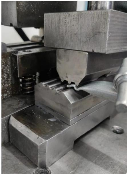
**Figura 17.** Sellado y prensado de tubos. **Fuente:** Autor.
