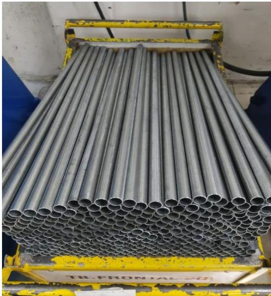
**Figura 9.** Tubo galvanizado de  $\text{Ø} 16.2\text{mm}$ . **Fuente:** Autor.
