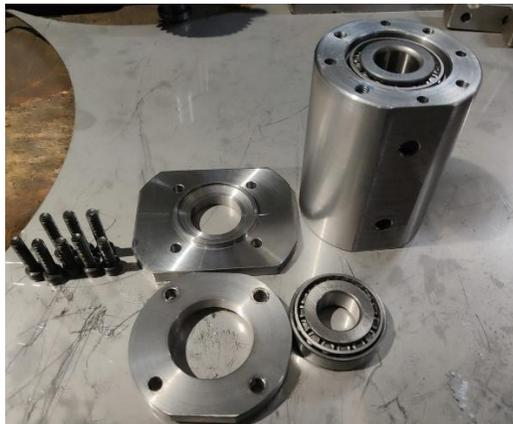
**Figura 35.**Cuerpo del rotor. **Fuente:** autor
