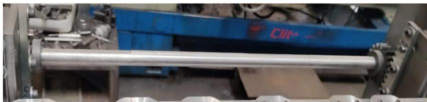
**Figura 36.**Eje de tracción de cremallera. **Fuente:** Autor
