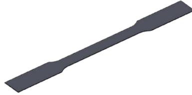
Figura 8-10 diseño3D probeta.
