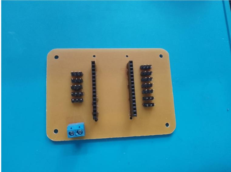
Figura 70. Soldar los componentes en la placa
