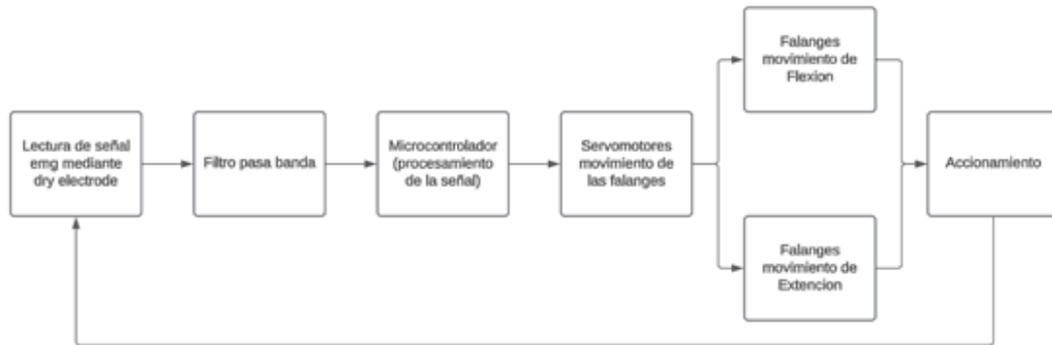
Figura 37. Diagrama de flujo del procesamiento de la señal mioeléctrica, autor propio.
