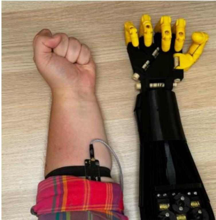
Figura 18. Prótesis controlada por sensor mioeléctrico seco [22].
