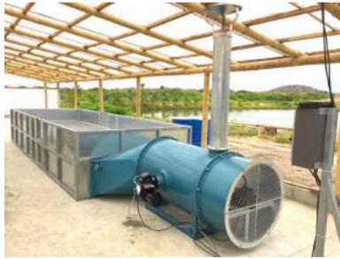
Figura 6: Cilindro intercambiador de calor [21].
