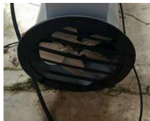
Figura 19: Ventilador axial 5 aspas [29].
