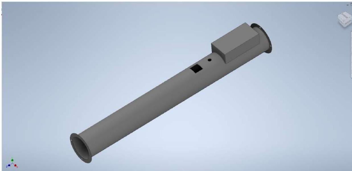
Figura 17: Prototipo de la tubería de secadora de cacao, fuente: El autor.
